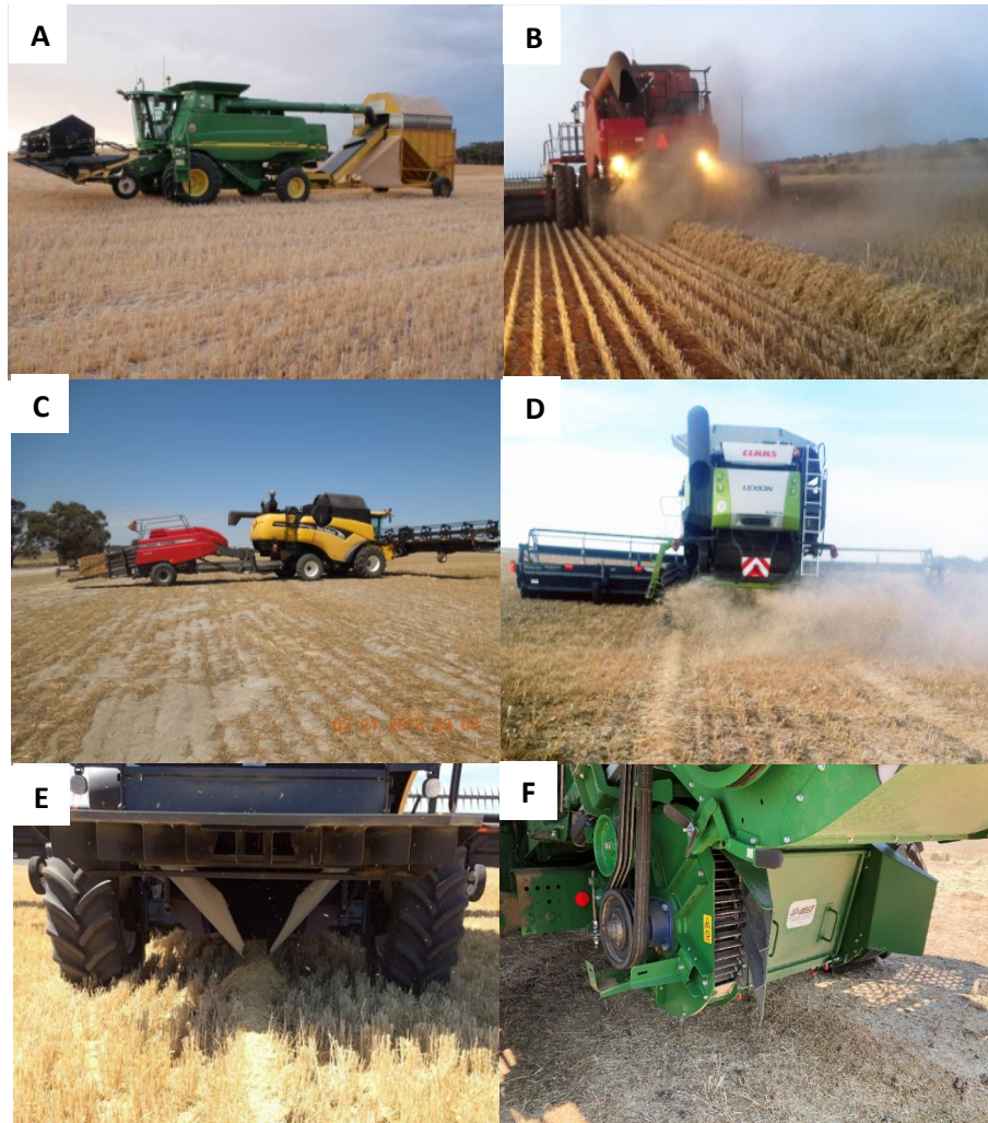
Figura 2. Sistemas de control de malezas a cosecha desarrollados por productores australianos apuntando a las semillas de malezas durante la cosecha del cultivo A) carro colector de granza, B) quemado de hileras de rastrojo, C) Sistema de enrollado directo, D) hilerado de granza para planteos de alto tránsito, E) hilerado de granza y F) Sistema de Molino de impacto.
